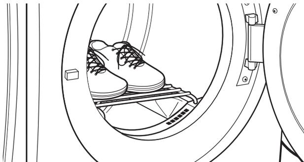
3. Placer les articles mouillés sur la grille de séchage. Laisser suffisamment d'espace entre les articles pour permettre à l'air de circuler. Le tambour tourne, mais la grille ne bouge pas; veiller à laisser suffisamment d'espace entre les articles et à l'intérieur du tambour de la sécheuse. Veiller à ce que les articles ne pendent pas par-dessus les bords de la grille de séchage ou entre les barreaux de la grille.
