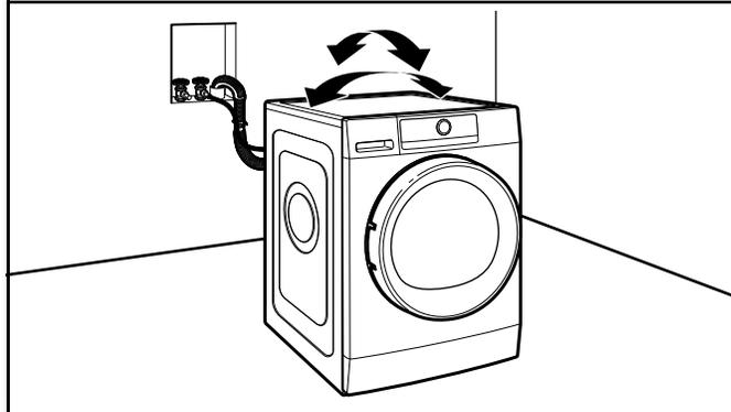
Sujete la lavadora/secadora de la parte superior y balancéela de atrás hacia delante, asegurándose de que las cuatro patas estén firmes en el piso. Repítalo, balanceando la lavadora de un lado al otro. Si se balancea la lavadora, vaya al paso 15 y regule las patas niveladoras. Si las cuatro patas hacen contacto firme con el piso, vaya al paso 17.
