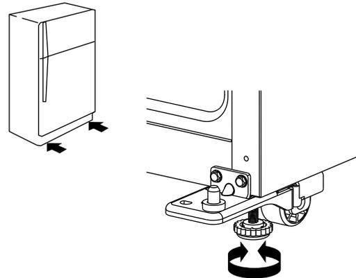
2. Ouvrir à nouveau les deux portes et vérifier que leur fermeture est aussi aisée que vous le souhaitez. Si ce n'est pas le cas, incliner le réfrigérateur un peu plus vers l'arrière en tournant les deux pieds de nivellement vers la gauche. Plusieurs tours seront peut-être nécessaires.
