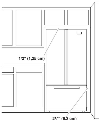
Pour obtenir une aération appropriée pour ce réfrigérateur, laisser un espace de 1/2 po (1,25 cm) de chaque côté et au sommet. Laisser un espace de 1 po (2,54 cm) derrière le réfrigérateur.
