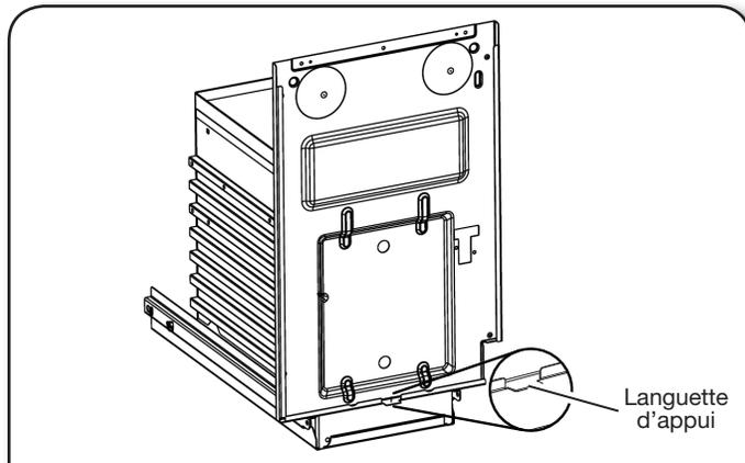
Fixer le panneau personnalisé à l'avant du tiroir extérieur en utilisant quatre vis à bois no 8 x 1 po. Visser de l'intérieur du tiroir. Il y a sept trous pour les vis.
