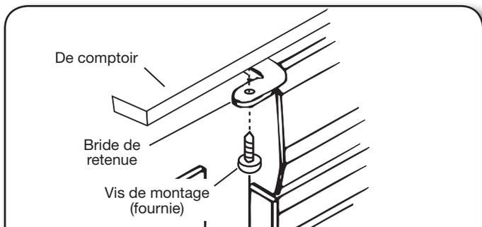
**REMARQUE :** Si les brides de retenue ne peuvent pas être fixées sous le comptoir, voir la section "Montage à l'avant de l'armoire".
