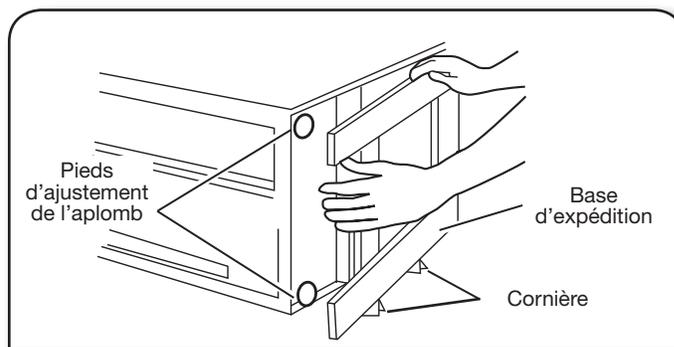
**REMARQUE :** Avant de remettre le compacteur debout, régler au besoin la hauteur du compacteur en utilisant les instructions de réglage de la hauteur suivantes.
