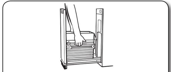
4. Passer l'aspirateur à l'intérieur de la caisse. Les liquides renversés ou les déchets humides doivent être nettoyés à la main ou au moyen d'un aspirateur conçu pour aspirer les liquides.
