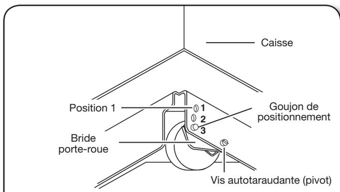
2. Placer le compacteur à la verticale. Si la hauteur de la roue arrière doit être réglée, déplacer les cornières de protection au côté opposé et placer le compacteur sur son autre côté. Régler l'autre roue arrière.
