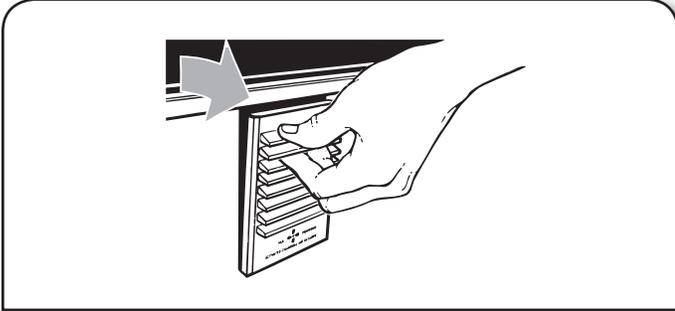
2. Retirer le filtre à air en tirant sur la partie supérieure du filtre. Le filtre devrait être facile à enlever. Jeter le filtre usagé.
