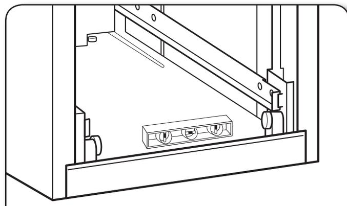
7. À l'aide des deux vis no 8 - 18 x 1/2 po (13 mm), fixer les brides de retenue en dessous du comptoir avec les vis de montage.
