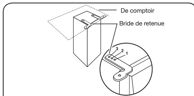
5. Soulever lentement et légèrement le devant et faire rouler le compacteur dans l'ouverture d'encastrement.
