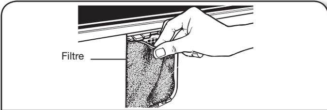
3. Pour placer le filtre à air de remplacement, insérez-le en place.
