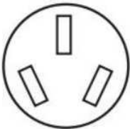
Tomacorriente de 3 hilos (10-50R)
