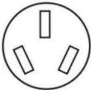
Tomacorriente de 3 hilos (10-50R)
