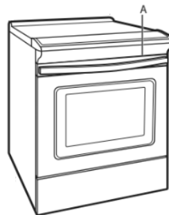
A. La plaque signalétique se trouve derrière la porte du four, dans le coin supérieur droit du châssis.
