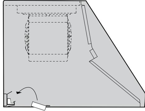
3. Commencer avec un filtre externe. Glisser le filtre vers le haut en direction de l'avant de la hotte puis enfoncer-le sur le dessus du plateau à graisse.
