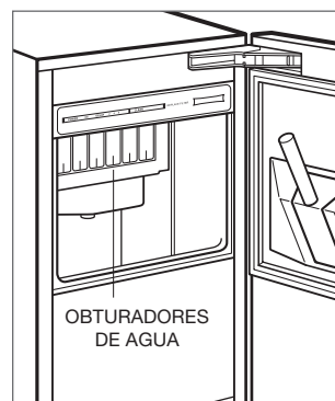
Ubicación de los obturadores de agua
