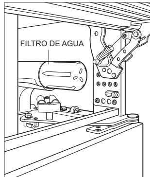
Extracción del filtro de agua
