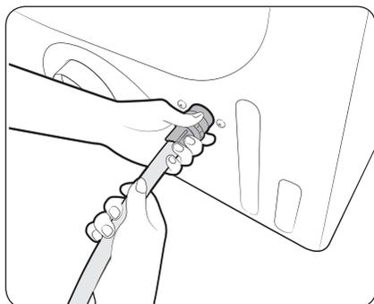
4. Branchez la partie coudée du tuyau d'eau au robinet de remplissage situé en bas du panneau arrière. Tournez le raccord à la main jusqu'à ce qu'il soit serré.
