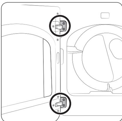
12. Réinstallez le hublot sur le cadre avant, puis insérez et serrez soigneusement les 4 vis de charnières.
