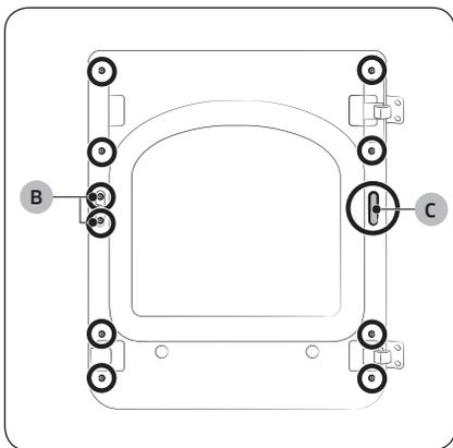
10. Retirez le **cache du trou (C)**, puis insérez et serrez le dispositif de fixation du verre à l'aide des 10 vis retirées.
