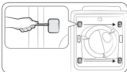
6. Utilisez un tournevis à tête plate pour retirer les deux caches de charnières sur le côté d'origine. Installez les caches de charnières sur le côté opposé, comme indiqué.
