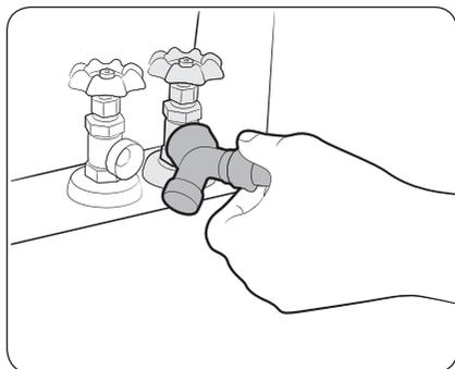
1. Fermez le robinet d'eau froide. Si le tuyau d'eau froide du lave-linge est raccordé au robinet d'eau froide, dévissez-le et débranchez-le. Branchez ensuite l'extrémité femelle du raccord en Y au robinet d'eau froide.
