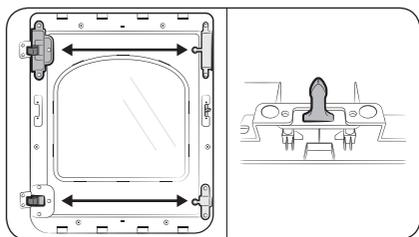
8. Retirez le dispositif de fixation du verre et inversez les positions :
