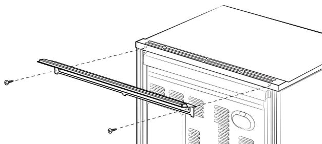
2. Assemblez la bande de fileur à l'arrière de la cuisinière à l'aide des vis retirées.
