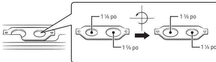
Retirez la plaque de raccordement des conduits et faites-la tourner comme illustré ci-dessous.
