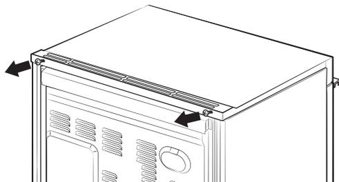
1. Dévissez les vis de montage de la protection du ventilateur.
