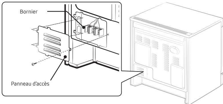
À l'aide d'un tournevis, desserrez puis retirez la vis du panneau d'accès situé à l'arrière de l'appareil. Retirez le panneau d'accès situé à l'arrière en le tirant bien droit pour le faire sortir. Le bornier sera alors accessible.
