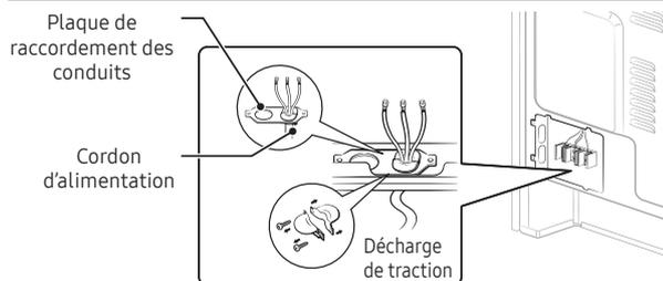
Pour l'installation du cordon d'alimentation, accrochez la décharge de traction sur le trou du cordon d'alimentation (1 3/8 po) situé sous l'arrière du corps du tiroir. Insérez le cordon d'alimentation à travers la décharge de traction et serrez le dispositif.
