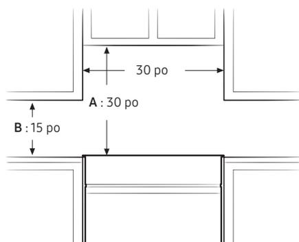
**IMPORTANT** : Pour éliminer les risques de brûlures ou d'incendie causés par le passage de la main sur les éléments chauffés, évitez de disposer d'un espace de rangement au-dessus des éléments. Si vous disposez d'un espace de rangement au-dessus des éléments chauffants, vous pouvez réduire le risque en installant une hotte qui dépasse horizontalement d'au moins 5 pouces les bas des armoires.
