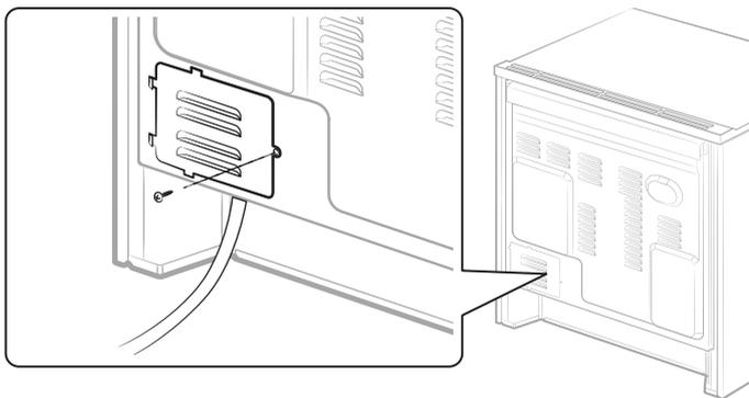
Pour remettre en place le panneau d'accès derrière la cuisinière. Insérez les deux parties en saillie situées en bas du panneau dans les orifices situés sous l'ouverture, puis insérez et serrez la vis du panneau d'accès situé à l'arrière.
