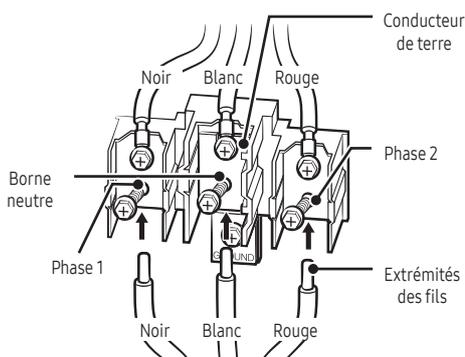
• Un fil de bâtiment en aluminium peut être utilisé mais il devra être doté de l'intensité et de la tension nominales correctes. Raccordez les fils comme décrit ci-dessous.
