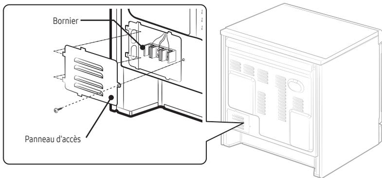
Desserrez puis retirez la vis du panneau d'accès situé à l'arrière à l'aide d'un tournevis. Retirez le panneau d'accès situé à l'arrière en le tirant bien droit pour le faire sortir. Vous pourrez alors accéder au bornier.
