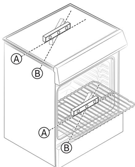
Utilisez un niveau à bulle pour vérifier vos réglages. Placez le niveau en diagonale sur la grille du four ou la table de cuisson et vérifiez le niveau dans les deux directions indiquées ci-dessous.
