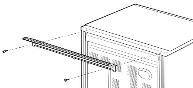
2. Installez la baguette à l'arrière de la cuisinière à l'aide des vis retirées.
