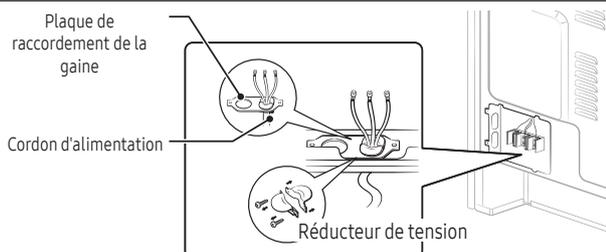
Pour l'installation du cordon d'alimentation, accrochez le réducteur de tension sur l'orifice du cordon d'alimentation (1<sup>3</sup>/<sub>8</sub>" ) situé sous la partie arrière du tiroir. Insérez le cordon d'alimentation dans le réducteur de tension et serrez ce dernier.
