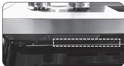
Cet appareil doit être alimenté par une tension et à une fréquence adaptées. Il doit également être branché sur un circuit de dérivation individuel correctement mis à la terre et protégé par un disjoncteur ou un fusible dont l'ampérage est conforme à celui spécifié sur la plaque signalétique de l'appareil. La plaque signalétique est située au bas du tableau de commande.
