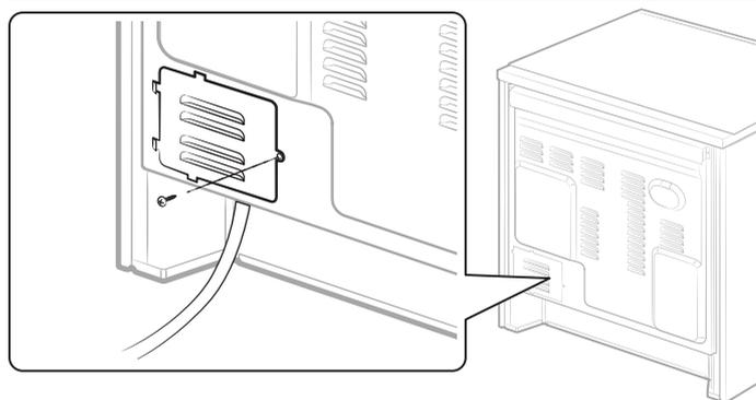
Pour remettre en place le panneau d'accès situé à l'arrière de la cuisinière, insérez les deux parties en saillie situées en bas du panneau dans les orifices situés sous l'ouverture, puis insérez et serrez la vis du panneau d'accès situé à l'arrière.
