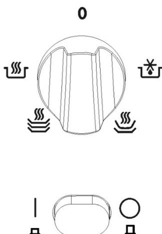
Le tableau de commandes comporte un sélecteur de fonction et un bouton marche/arrêt. Le tableau de commandes n'est visible que lorsque le tiroir est ouvert.
