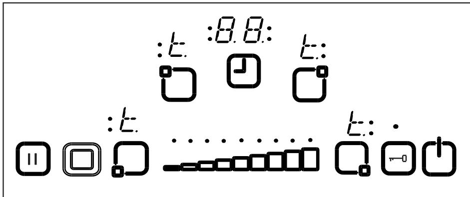
Après la baisse de température, la lettre T disparaît et l'unité de contrôle de la plaque passera au *Mode S*. Ceci signifie que l'utilisateur peut réactiver l'appareil en appuyant sur .
