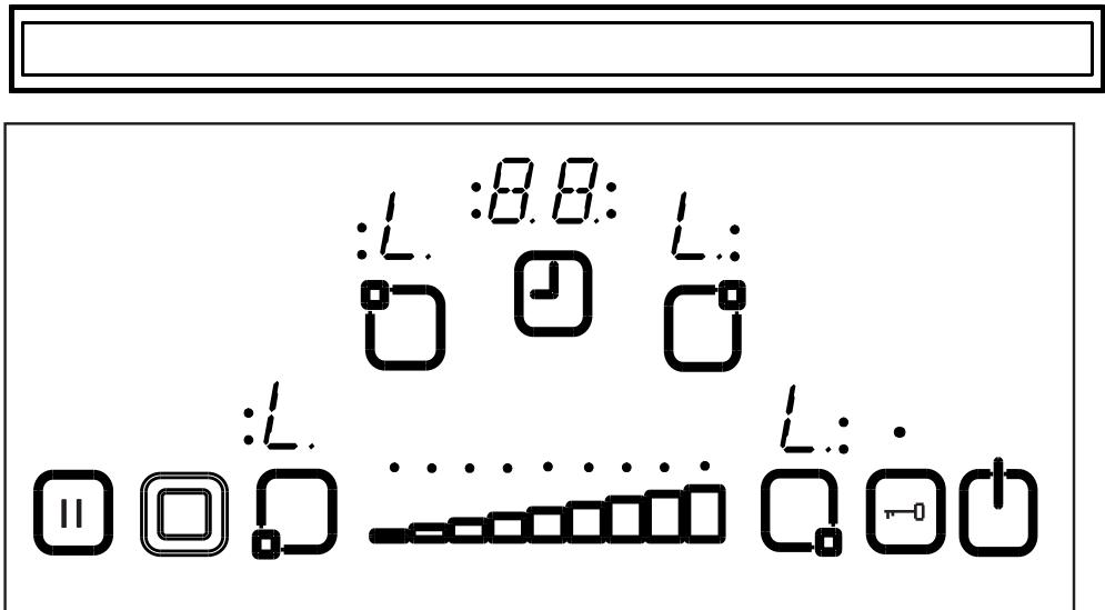
Si le rappel de minutes est encore en fonctionnement, celui-ci continuera jusqu'à ce qu'il atteigne «00» et la minuterie émettra un signal sonore. Après la confirmation de l'exécution de la minuterie, l'appareil sera complètement verrouillé. Aucune touche ne peut être utilisée tant que l'appareil est bloqué.
