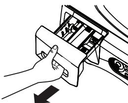
Vous pourriez voir de l'eau dans le tiroir du distributeur à la fin du cycle. Ceci est le résultat de l'action de rinçage/siphonnage et fait partie du fonctionnement normal de la laveuse.
