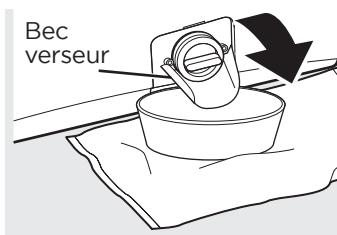
4. Tournez le filtre de la pompe dans le sens antihoraire et retirez le filtre. Ouvrez lentement pour permettre à l'eau de s'écouler.
