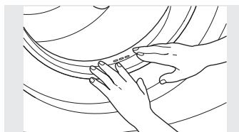
2. Tout en maintenant le joint d'étanchéité de porte enfoncé, inspectez le joint d'étanchéité intérieur en le tirant vers le bas avec vos doigts. Retirez tout corps étranger qui pourrait être coincé à l'intérieur du joint d'étanchéité. Assurez-vous que rien ne bloque les trous derrière le joint d'étanchéité.
