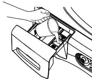
Ne dépassez pas la ligne de remplissage maximale. Un remplissage excessif peut entraîner une distribution précoce de l'eau de Javel, ce qui pourrait endommager les vêtements.
