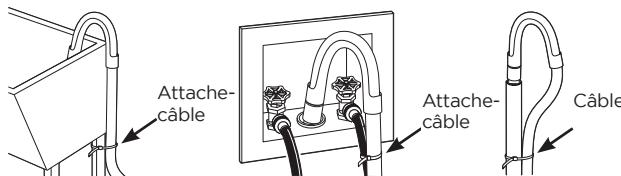
**REMARQUE :** Placer le tuyau de vidange trop loin dans le tuyau de vidange peut provoquer un siphonnage. Pas plus de 17,78 cm (7 po) de tuyau dans le tuyau de vidange. Un espace d'air doit être présent autour du tuyau de vidange. Un ajustement serré peut également provoquer un siphonnage.
