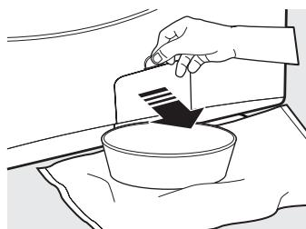
2. Placez une assiette ou un plat peu profond sous la porte d'accès à la pompe et des serviettes sur le plancher devant la laveuse pour protéger le plancher. Il est normal de recueillir environ 250 ml (1 tasse d'eau) lorsque le filtre est retiré.
