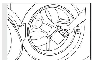
3. Fermez la porte, puis sélectionnez le cycle de Tub Clean (Nettoyage de la cuve). Appuyez sur le bouton **▷II**.
