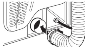
Con una abrazadera de 4" (102 mm), conecte el ducto de escape a la salida de escape en la secadora. Si se conecta a un ducto de escape existente, asegúrese de que el mismo esté limpio. El ducto de escape de la secadora debe encajar sobre la salida de escape de la secadora y dentro de la capota de ventilación. Cerciórese de que el ducto de escape esté asegurado a la capota de ventilación con una abrazadera de 4" (102 mm).
