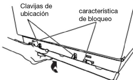
Para instalar: Coloque el faldón en el fondo de la secadora y haga coincidir las clavijas de ubicación con los orificios. Presione con firmeza el faldón hacia arriba hasta que quede colocado a presión en su lugar.
