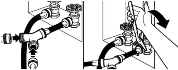
Conecte uno de los extremos de la manguera de entrada de 5 pies (1,5 m) de la secadora al conector en "Y". Fije la manguera de entrada de agua fría de la lavadora al otro lado del conector en "Y". Enrosque el acoplamiento con la mano hasta que quede asentado en el conector. Con las pinzas, apriete los acoplamientos dos tercios de vuelta adicionales.
