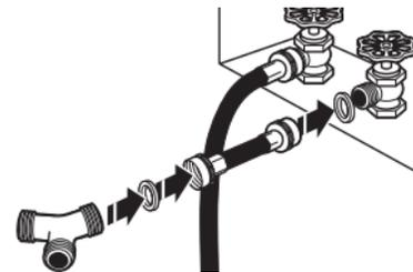
Fije la manguera de entrada de 2 pies (0,6 m) al grifo de agua fría. Enrosque el acoplamiento con la mano hasta que quede asentado en el grifo. Luego sujete el conector en "Y" al extremo macho de la manguera de entrada de 2 pies (0,6 m). Enrosque el acoplamiento con la mano hasta que quede asentado en el conector.
