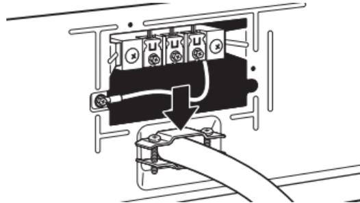
Haga pasar el cable eléctrico a través del protector de cables. Asegúrese de que el aislamiento de cables del cable eléctrico esté dentro del protector de cables. El protector de cables deberá encajar de manera ajustada con el gabinete de la secadora y estar en posición horizontal. Apriete el tornillo del protector de cables contra el cable eléctrico. No apriete en exceso los tornillos del protector de cables.
