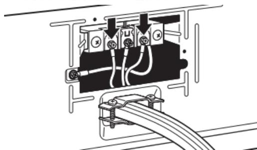
Conecte los cables restantes bajo los tornillos externos del bloque de terminal. Apriete los tornillos. Inserte la lengüeta de la tapa del bloque de terminal dentro de la ranura del panel posterior de la secadora. Asegure la tapa con un tornillo de sujeción. Ahora vaya a "Requisitos de ventilación".
