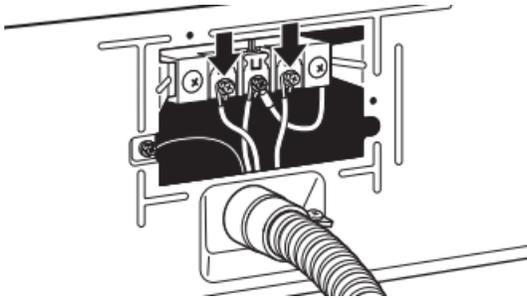
Coloque los extremos en forma de gancho de los hilos restantes del cable de conexión directa debajo de los tornillos exteriores del bloque de terminal (con los ganchos mirando hacia la derecha). Apriete los extremos en forma de gancho y apriete los tornillos. Inserte la lengüeta de la tapa del bloque de terminal dentro de la ranura del panel posterior de la secadora. Asegure la tapa con un tornillo de sujeción. Ahora vaya a "Requisitos de ventilación".
