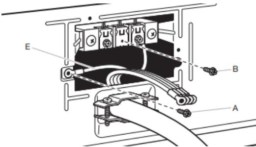
Quite el tornillo central del bloque de terminal (B). Saque el hilo neutro de enlace (E) del tornillo conductor a tierra externo verde (A).
