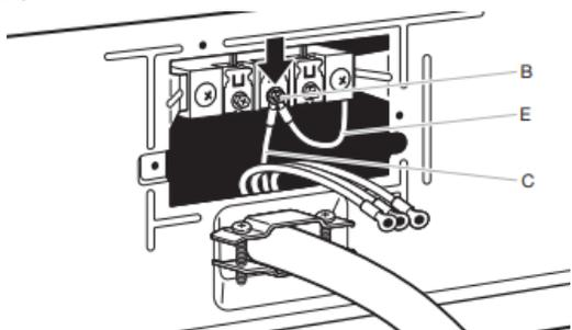
Conecte el hilo neutro de enlace (E) y el hilo neutro (hilo blanco o central) (C) del cable eléctrico debajo del tornillo central del bloque de terminal (B). Apriete el tornillo.
