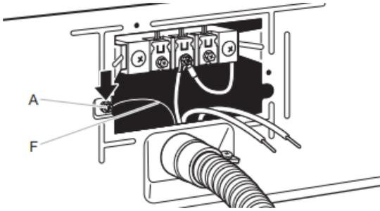
Conecte el hilo a tierra (verde o desnudo) (F) del cable directo al tornillo conductor a tierra externo verde (A). Apriete el tornillo.
