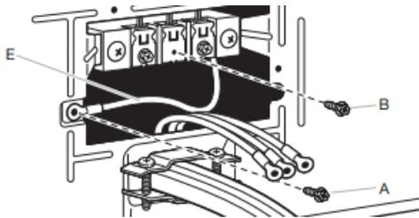
Instale el protector de cables correcto según su método de conexión eléctrica. Quite el tornillo central del bloque de terminal (B). Saque el hilo neutro de enlace (E) del tornillo conductor a tierra externo verde (A).
