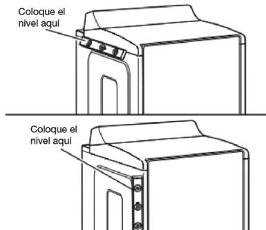
Revise la nivelación de la secadora de lado a lado. Repita el procedimiento de adelante hacia atrás.
