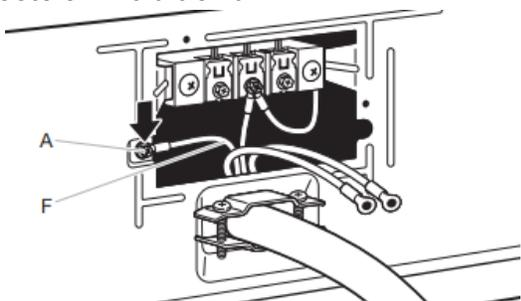
Conecte el hilo a tierra (F) (verde o desnudo) del cable de suministro eléctrico al tornillo conductor a tierra externo verde (A). Apriete el tornillo.
