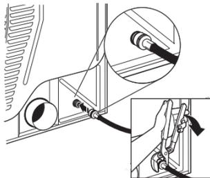
Si corresponde, retire la tapa protectora de la válvula de entrada de agua. Sujete el otro extremo de la manguera larga a la válvula de llenado en el panel posterior de la secadora. Atornille el acoplamiento con la mano hasta que quede asentado en el conector de la válvula de llenado. Con las pinzas, apriete los acoplamientos dos tercios de vuelta adicionales.
