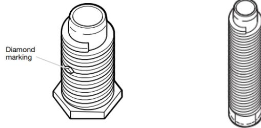
Pata niveladora con marca en forma de diamante.
