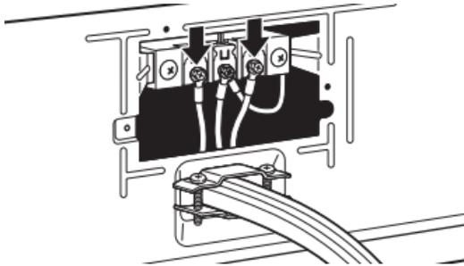
Coloque los alambres restantes bajo los tornillos externos del bloque de terminal. Ajuste los tornillos.
