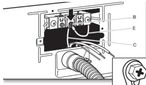
Conecte el hilo neutro de enlace (E) y coloque el extremo en forma de gancho (gancho mirando hacia la derecha) del hilo neutro (blanco o central) (C) del cable de conexión directa debajo del tornillo central del bloque de terminal (B). Apriete los extremos en forma de gancho y apriete el tornillo.
