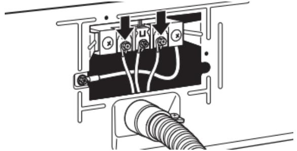
Coloque los extremos en forma de gancho de los hilos restantes del cable de conexión directa debajo de los tornillos exteriores del bloque de terminal (con los ganchos mirando hacia la derecha). Apriete el extremo en forma de gancho y apriete los tornillos. Inserte la lengüeta de la tapa del bloque de terminal dentro de la ranura del panel posterior de la secadora. Asegure la tapa con un tornillo de sujeción. Ahora vaya a "Requisitos de ventilación".
