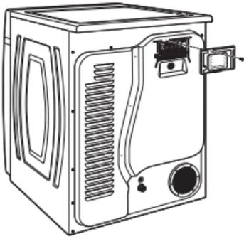
Quite el tornillo de sujeción y la cubierta de la caja de terminal.
