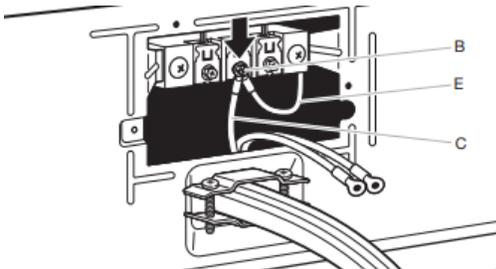
Conecte el cable neutro de enlace (E) y el cable neutro (hilo blanco o central) (C) del cable eléctrico debajo del tornillo central del bloque de terminal (B). Apriete el tornillo.
