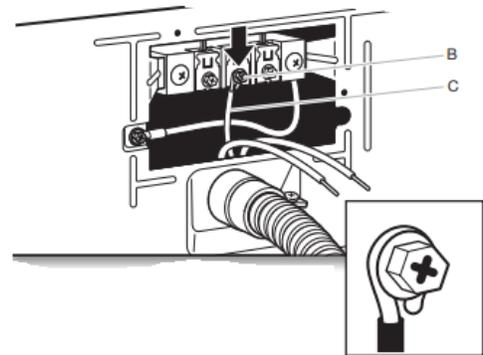
Coloque el extremo en forma de gancho del hilo neutro (blanco o central) (C) del cable directo debajo del tornillo central (B) del bloque de terminal. Apriete y junte el extremo en forma de gancho. Apriete el tornillo.
