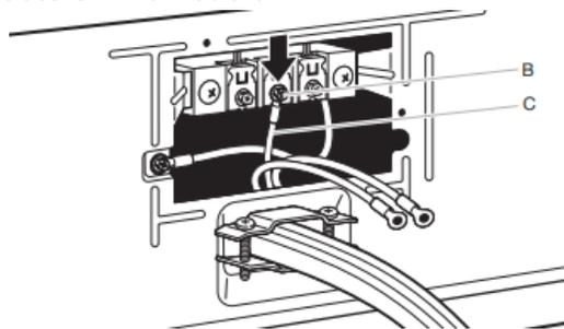
Conecte el hilo neutro (hilo blanco o central) (C) del cable de suministro eléctrico bajo el tornillo central del bloque de terminal (B). Apriete el tornillo.
