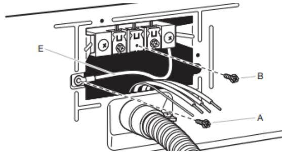
Quite el tornillo central del bloque de terminal (B). Saque el hilo neutro de enlace (E) del tornillo conductor de enlace externo verde (A).
