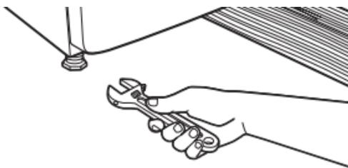
Si la secadora no está nivelada, apúntela con un bloque de madera. Use una llave para regular las patas hacia arriba o hacia abajo y verifique nuevamente si la secadora está nivelada.
