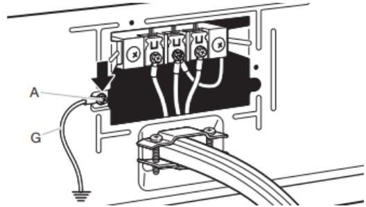
Conecte un hilo a tierra de cobre separado (G) desde el tornillo conductor a tierra externo verde (A) a una conexión a tierra adecuada. Inserte la lengüeta de la tapa del bloque de terminal dentro de la ranura del panel posterior de la secadora. Asegure la tapa con un tornillo de sujeción. Ahora vaya a "Requisitos de ventilación".
