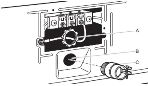
Desatornille el conector de conducto removible (A) y cualquier tornillo del protector de cables de 3/4" (19 mm) que esté en la lista de UL (con la marca UL en el protector de cables). Haga pasar la sección trenzada del protector de cables a través del orificio que está debajo de la abertura del bloque de terminal (B). Busque dentro de la apertura del bloque de terminal, atornille el conector del conducto removible (A) sobre las roscas del protector de cables (C) y apriételo correctamente.
