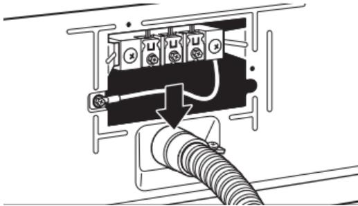
Haga pasar el cable directo a través del protector de cables. El protector de cables deberá encajar de manera ajustada con el gabinete de la secadora y estar en posición horizontal. Apriete el tornillo del protector de cables contra el cable directo.
