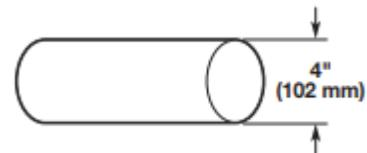
■ Solo puede usarse un ducto de escape de metal pesado de 4" (102 mm) y abrazaderas.
