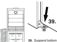
39. Suspend bottom door on hinge pin.
