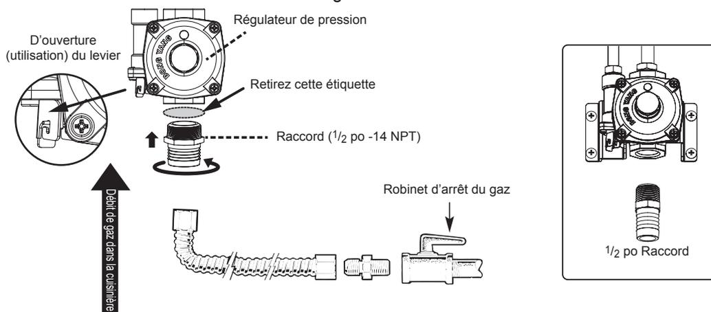
Installateur : Informez le client de l'emplacement du robinet d'arrêt du gaz.
