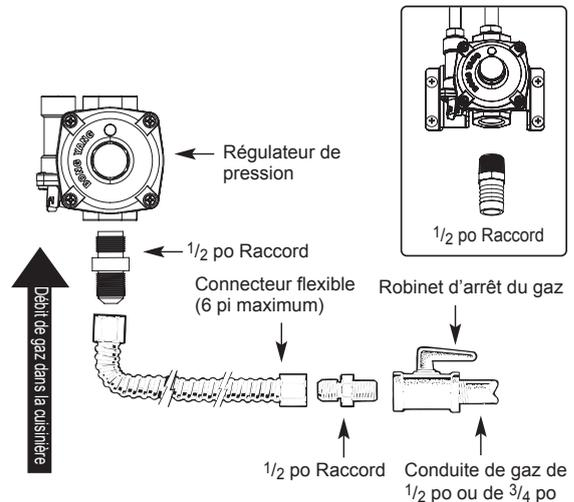
Installateur : Informez le client de l'emplacement du robinet d'arrêt du gaz.
