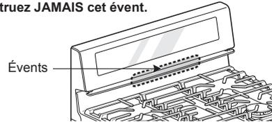
**Ne couvrez pas la surface de cuisson avec une feuille d'aluminium. Le fait de bloquer la ventilation du four peut endommager le panneau de commande.**
