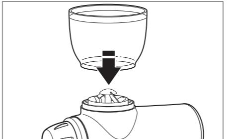
1. S'assurer que le moulin à café est débranché. Fixer la trémie à la partie supérieure du logement du moteur en la tournant dans le sens horaire jusqu'à ce qu'elle soit bien serrée.
