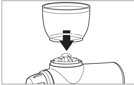
1. Asegúrese de que el molinillo de placas esté desenchufado. Fije la tolva de granos a la parte superior del alojamiento del motor, gire en sentido de las agujas del reloj hasta ajustar.
