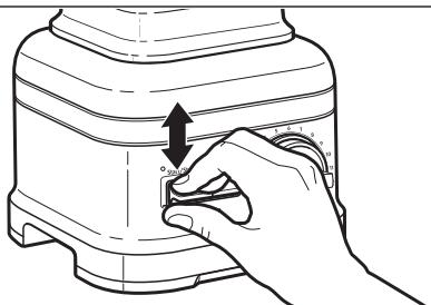
**7** Après avoir mélangé, faire basculer l'interrupteur START/STOP (marche/arrêt) vers le haut ou le bas. Permettre au mélangeur d'arrêter complètement avant d'enlever le couvercle et de verser les ingrédients.
