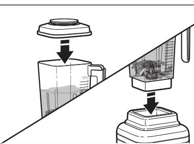
**2** Vous assurer que le couvercle est bien positionné sur le récipient; placer ensuite le récipient sur le socle en vérifiant qu'il est bien aligné sur le capuchon inférieur.
