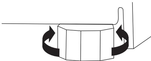
3. Enlever le niveau et fermer le tiroir supérieur. Contrôler l'espace entre le sommet du tiroir et le plan de travail. Si l'espace mesure moins de 3/8 po (9,5 mm), tourner uniformément les quatre boulons de réglage de l'aplomb vers la gauche pour relever les pieds de nivellement (ce qui abaissera l'appareil). Contrôler l'aplomb de nouveau.
