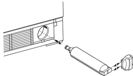
3. Retirer le filtre neuf de son emballage, puis retirer les protections des anneaux d'étanchéité.
