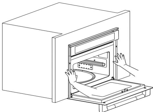
3. Fixer solidement le four à micro-ondes à l'armoire à l'aide des deux vis à tête plate de 3/4 po (1,9 cm) fournies. Insérer les vis à travers les trous des glissières de montage. Ne pas serrer excessivement les vis.
