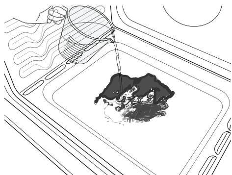
**IMPORTANT :** Ne pas utiliser des produits chimiques ou d'autres additifs avec l'eau. Ne pas ouvrir la porte du four au cours du programme de lavage. L'eau au fond du four est chaude.
