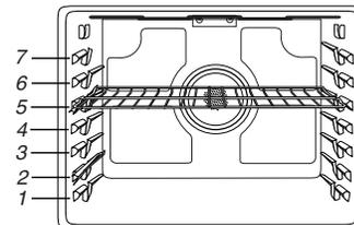
Le four possède 7 positions pour grille plate, comme indiqué dans l'illustration précédente et le tableau suivant.
