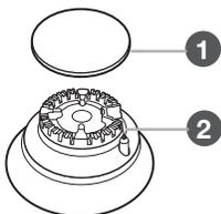
**IMPORTANT :** Ne pas entraver l'évacuation de l'air de combustion et de ventilation autour des bords des grilles de brûleur.
