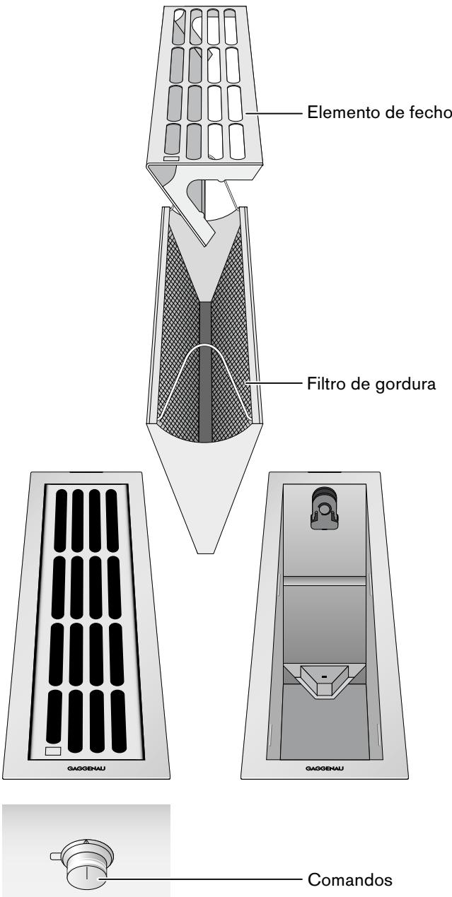
**Nota:** A ventilação de bancada VL 414 só pode operar em combinação com o comando AA 490 110/111. Ao AA 490 110/111 podem ser ligadas no máximo 4 VL 414. Os dados de operação são aplicáveis a todos os elementos de ventilação abertos.
