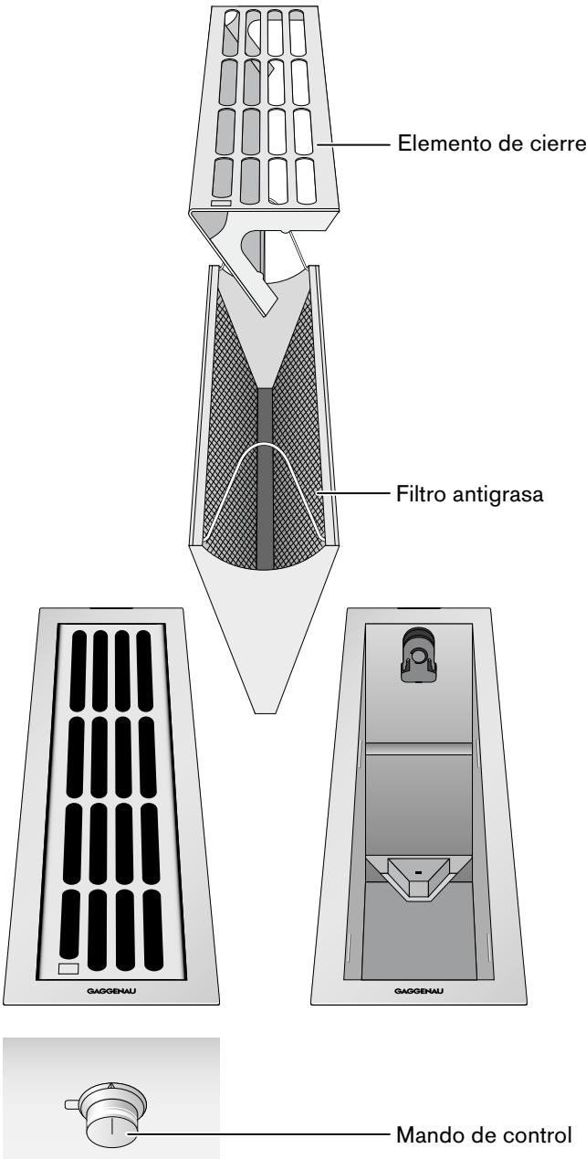
**Nota:** La ventilación de la zona de cocción VL 414 solo puede utilizarse en combinación con el mando de control AA 490 110/111. Al AA 490 110/111 pueden conectarse máximo cuatro VL 414. Las especificaciones de manejo son válidas para todos los elementos de ventilación abiertos.
