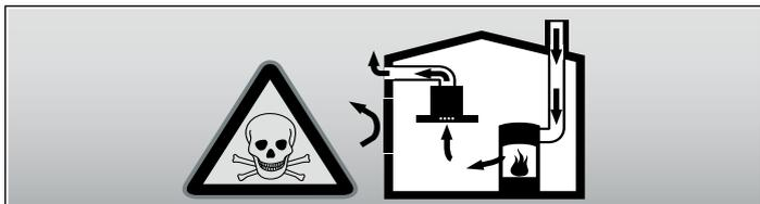
Ildsteder, hvis lufttilførsel sker fra indeluften, (f.eks. gas-, olie-, træ- eller kulfyrede varmeapparater, gennemstrømningsvandvarmere, vandvarmere) henter deres forbrændingsluft fra opstillingsrummet og fører røggassen ud gennem en røggaskanal (f.eks. skorsten) til det fri.
