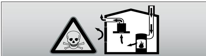
Ildsteder som er avhengig av romluft (f.eks. varmeapparater som drives med gass, olje eller kull, varmtvannsbereidere) bruker forbrenningsluften fra oppstillingsrommet og leder avgassene gjennom et avgassanlegg (f.eks. pipe) i det fri. I forbindelse med en innkoblet ventilator trekkes det romluft fra kjøkkenet og rommene ved siden av – uten tilstrekkelig tilførselsluft oppstår et undertrykk. Giftige gasser fra pipe eller avtrekkssjakt suges tilbake til oppholdsrommene.
