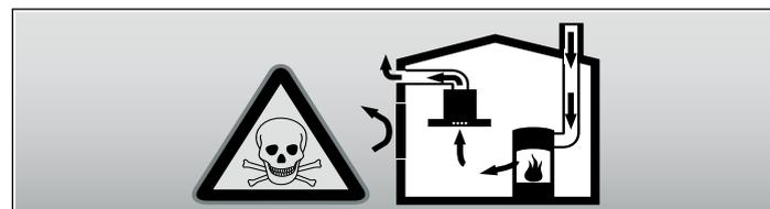
Huoneilmaa tarvitsevat tulisijat (esim. kaas-, öljy-, puu- tai hiilikäyttöiset lämmityslaitteet, läpivirtauskuumennin, vedenkuumennin) ottavat polttoilman huonetilasta ja johtavat poistoilman poistoilmalaitteen (esim. savutorven) kautta ulos.
