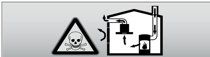
Los equipos calefactores que dependen del aire del recinto de instalación (p. ej., calefactores de gas, aceite, madera o carbón, calentadores de salida libre, calentadores de agua) adquieren aire de combustión del recinto de instalación y evacúan los gases de escape al exterior a través de un sistema extractor (p. ej., una chimenea).
