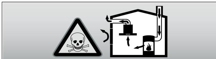
Εστίες, εξαρτημένες από τον αέρα του περιβάλλοντος (π.χ. συσκευές θέρμανσης που λειτουργούν με αέριο, πετρέλαιο, ξύλο ή άνθρακα, ταχυθερμοσίφωνες, θερμομαντήρες νερού) λαμβάνουν τον αέρα για καύση από το χώρο τοποθέτησης και οδηγούν τα καυσαέρια μέσα από μια εγκατάσταση απαγωγής των καυσαερίων (π.χ. καμινάδα) στον έξω χώρο.
