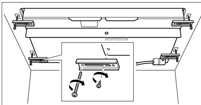
La placa debe asegurarse a la superficie de trabajo con los soportes de sujeción provistos, así que no se puede mover.
