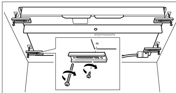
L'appareil doit être fixé au plan de travail pour éviter glissement avec les supports de fixation fournis.
