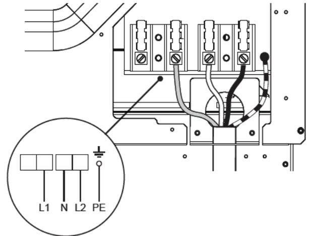
**Connexion à 3 fils (en utilisant le fil de masse fourni)**
