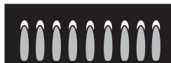
(B) Extrémités jaunes sur les cônes extérieurs — Normal pour le propane (LP)
