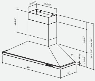
Installation en recirculation sans conduit possible au moyen de la cheminée télescopique réversible
